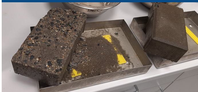
rozdíl v odpadu neošetřené a ošetřené dlažby po 50ti zmrazovacích cyklech
