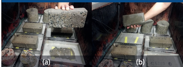
Obr. 2 příklady testování účinnosti prostředků vůči působení mrazu a rozmrazovacích solí (a) neošetřená a (b) ošetřená betonová dlažba po 50ti zmrazovacích cyklech dle ČSN 73 1326 v KD-20
