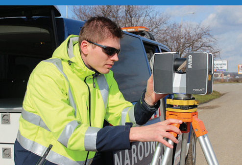
skenování deformací vozidla pomocí 3D skeneru
