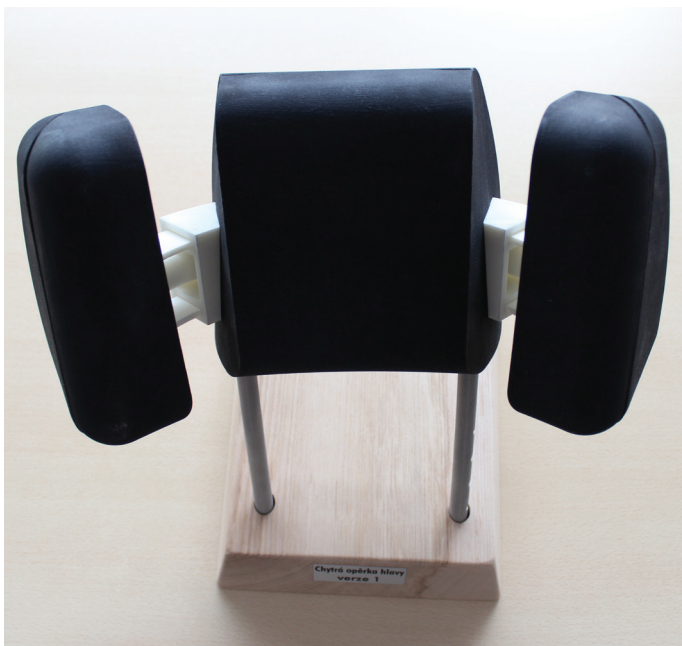
model aktivní opěrky z 3D tiskárny
